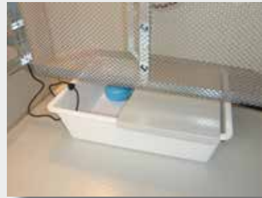
Umidificatore ultrasuoni ad una membrana One membrane ultrasounds humidifier
